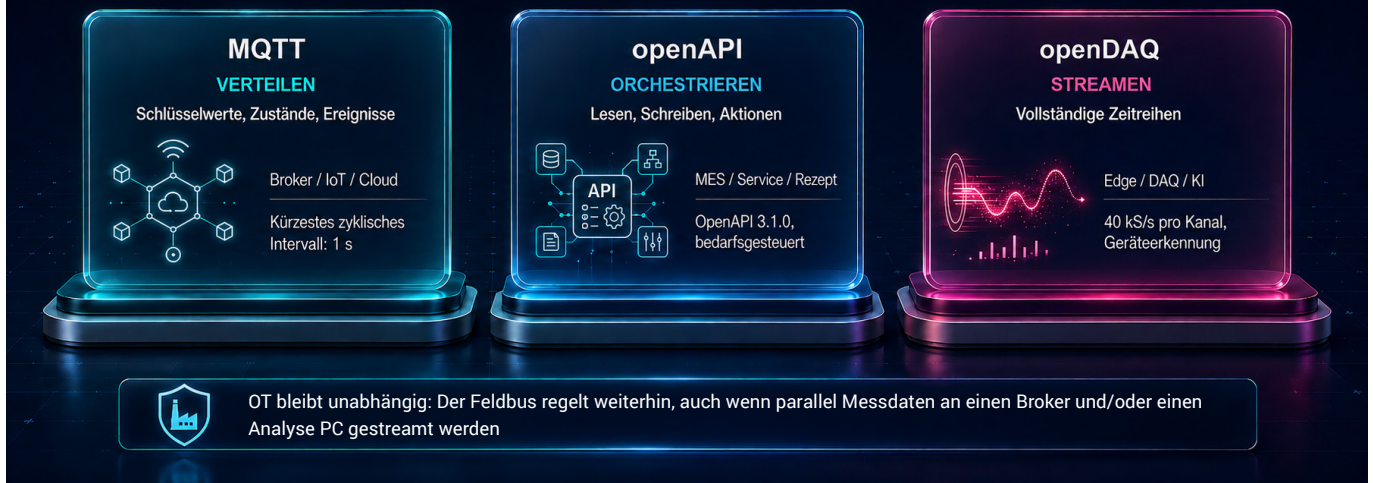
Abbildung 3: Aufgabenorientierte Differenzierung der IT-Protokolle MQTT, openAPI und openDAQ.
