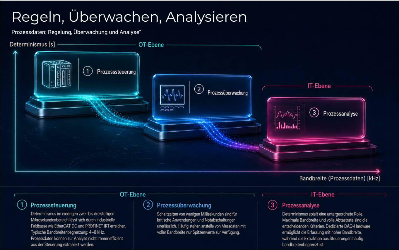
Abbildung 1: Rollenverteilung zwischen Prozessregelung, Prozessüberwachung und datenintensiver Analyse.
