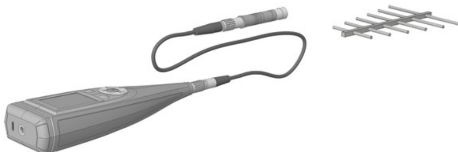
Abb. 3.2 Orientierung des Schallpegelmessers in Bezug auf den Sender/Empfänger hochfrequenter Felder
