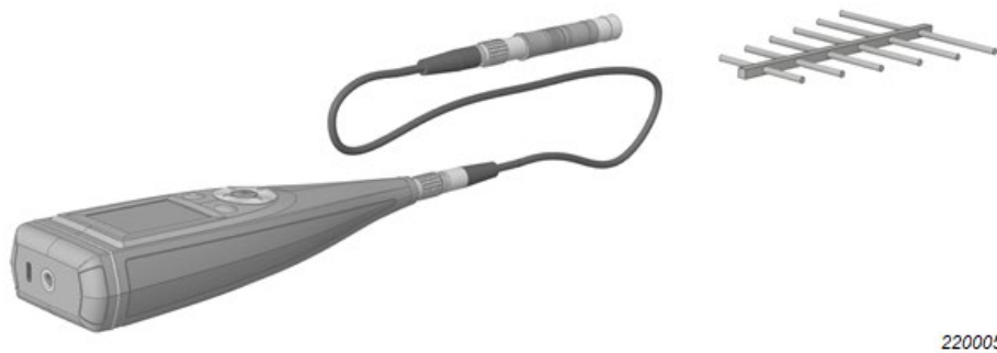
Fig. 3.2 Orientation de référence du sonomètre par rapport à l'émetteur-récepteur FR
