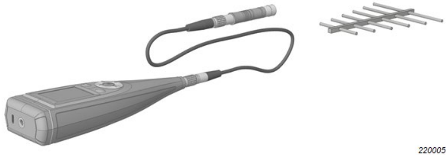
도 3.2 RF-송신기/수신기에 대한 소음 측정기의 기준 방향
