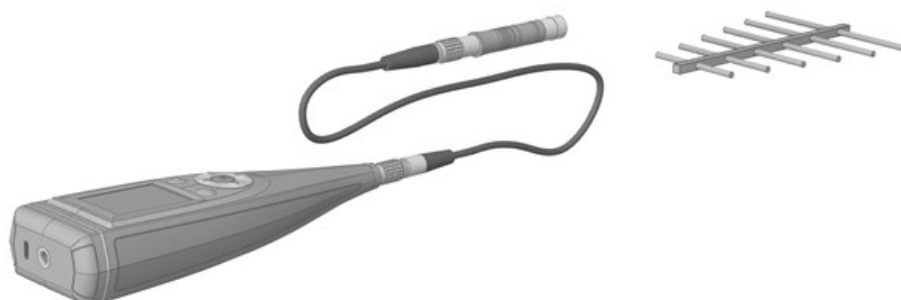
Fig. 3.2 Orientación de referencia del sonómetro con respecto al emisor/receptor de RF
